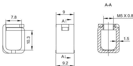
备注: (1) 产品部分外形尺寸未注尺寸公差, 当外形尺寸 $\leq 1\text{mm}$ , 公差为 $\pm 0.2\text{mm}$ ; 当外形尺寸在(1~5)mm之间时, 公差为 $\pm 0.3\text{mm}$ ; 当外形尺寸 $>5\text{mm}$ , 公差为 $\pm 0.4\text{mm}$ 。
